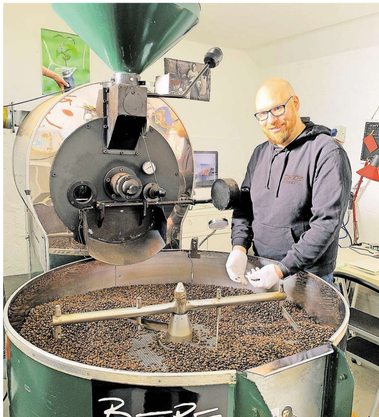
Traditionelles Verfahren mit digitaler Begleitung: Thomas Berg neben seiner türkischen Trommelröstmaschine, einer Has Garanti von 1980.
